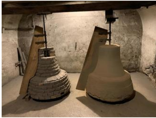
Glockengießerei Grassmayr, Bau einer Glocke
